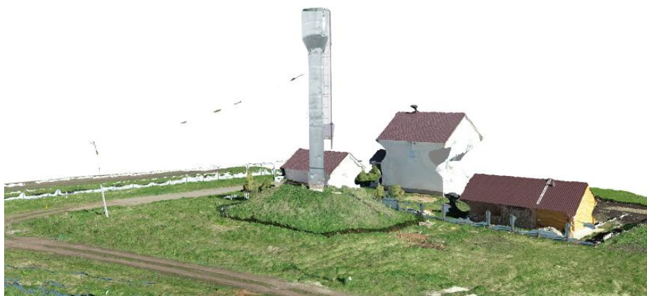
Рисунок 7– Трёхмерная модель с параметрами облака точек высокого качества (29 062 437 точек) и среднего качества модели (1 937 495 полигонов)
