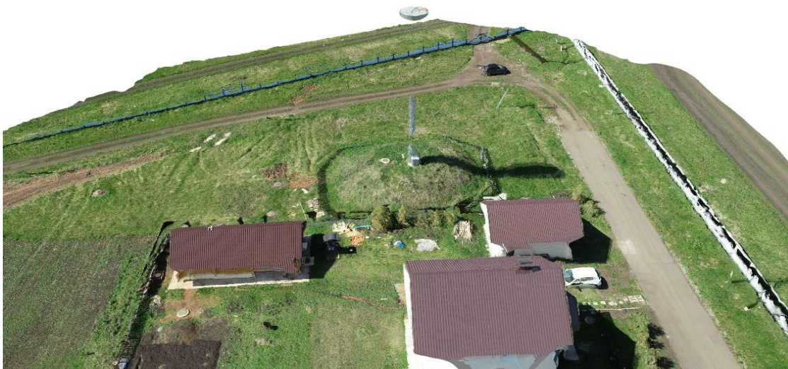
Рисунок 6 – Трёхмерная модель с параметрами облака точек высокого качества (29 062 437 точек) и низкого качества модели (645 830 полигонов)
