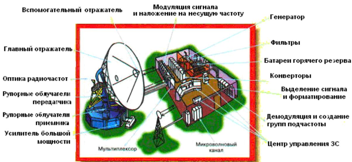
Рис. 1.4 ЭС с высокой пропускной способностью.
