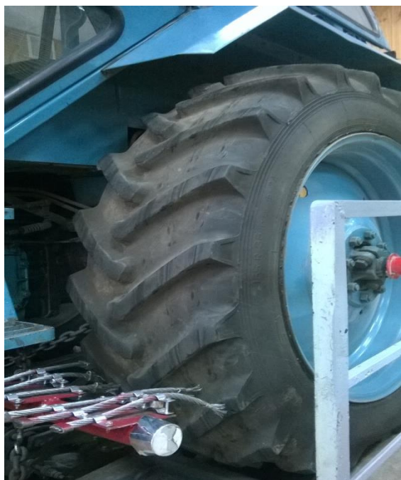
Рис.2. Устройство для очистки рисунка протектора колёсного движителя универсально-пропашного трактора в движении
