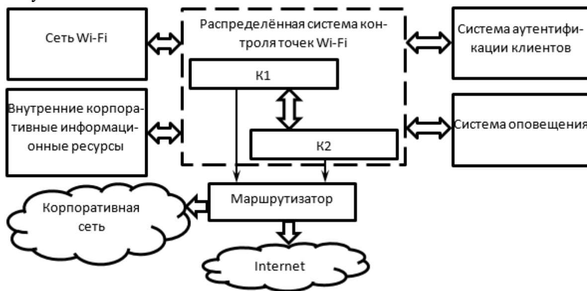
Рис. 1. Структурная схема распределённой системы управления беспроводной сетью кампуса университета где K1, K2 – контроллеры беспроводных сетей.
