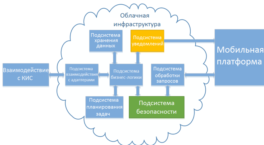
Рис. 1. Структура частного облака мобильного приложения КИС
