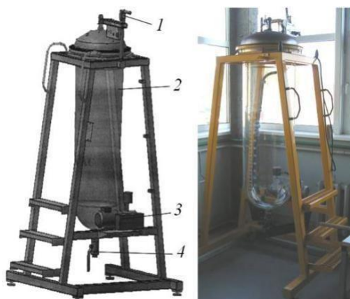
Рис. 21. Установка для очистки и сортировки семян «Prevac»: 1 – устройство заправки; 2 – вакуумный цилиндр; 3 – электропривод вакуумного компрессора; 4 – устройство опорожнения.
