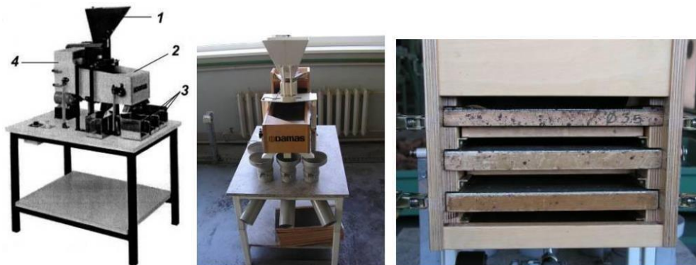
Рис. 23. Решетчатый сепаратор «Damas»: 1 – бункер для семян; 2 – система сит; 3 – сборники семян; 4 – вибрационная система.
