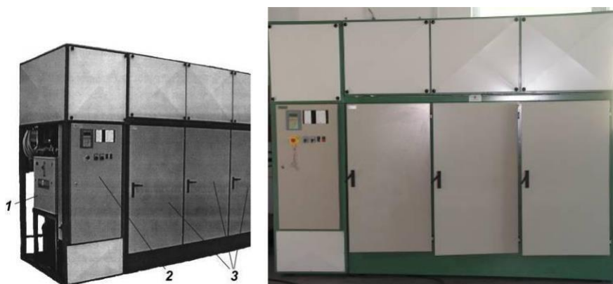
Рис. 24. Сушильный шкаф для сушки семян DC200/400 «Nomeko»: 1 – блок автоматики и управления; 2 – панель управления; 3 – сушильные секции
