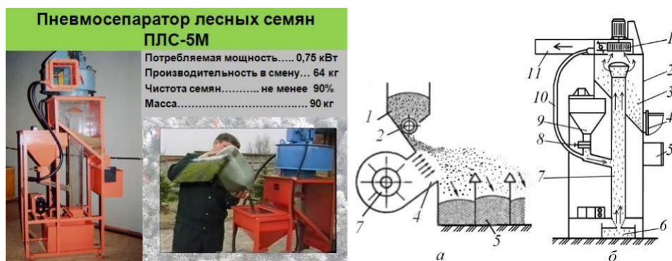
Рис. 13. Разделение семян в воздушном потоке: а – в наклонном потоке: 1– бункер; 2 – дозатор; 5 –осадочные камеры; 7 –вентилятор; б –в вертикальном потоке(ПЛС-5М): 1 –вентилятор; 2 –камера; 3 – осадочная камера крупных примесей; 4 – окно разгрузки; 5 – ящик для легких семян; 6 – камера с отделенными семенами; 7 – воздушный канал; 8 – дозатор; 9 – бункер семян; 10 – воздухопровод; 11 – отвод для пыли.
